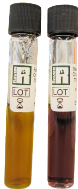
Figure 8 : Témoin positif (à gauche) et témoin négatif (à droite)
