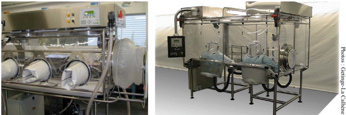
Figure 1 : Isolateur souple à trois gants (à gauche) et isolateur rigide à deux hémisphères (à droite)
