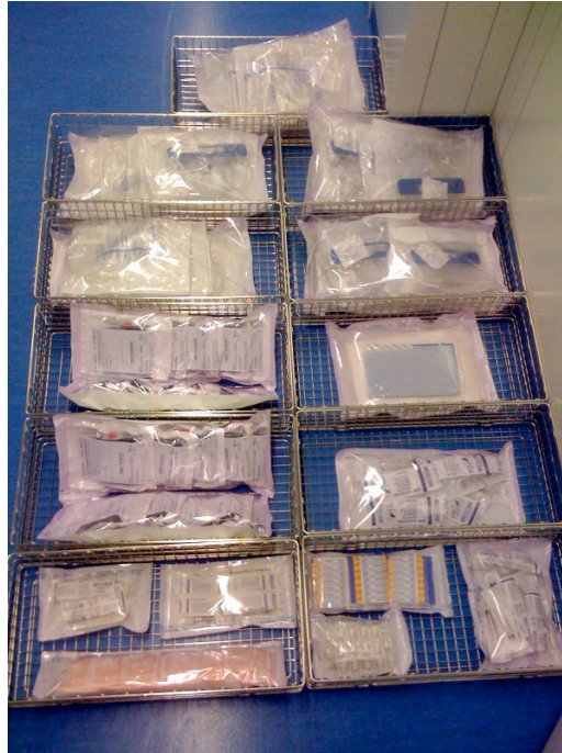
Figure 12 : Exemple de positionnement des kits dans les paniers avant le chargement de l'isolateur
