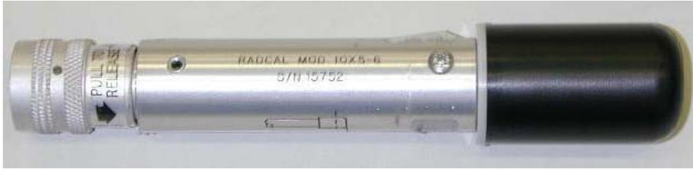
Figure 9.4 Exemple de chambre d'ionisation utilisée en radiodiagnostic (chambre Radcal de volume égal à 6 cm<sup>3</sup>).
