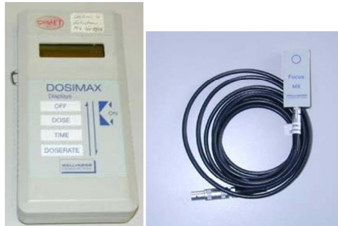
Figure 9.11 Exemple de dosimètre de radiodiagnostic comportant un détecteur semi-conducteur (Wellhöfer Dosimax).
